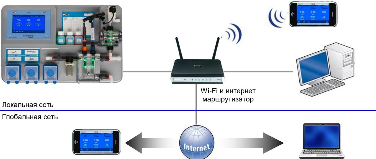
Для соединений необходимо использовать стандартный Ethernet сетевой кабель. После успешного соединения кабелей и подачи питания в левом верхнем углу дисплея отобразится символ . Имеющееся соединение позволяет получить удаленный доступ к MRD-3 в рамках локальной сети (смотри рисунок выше). Для этого необходимо в интернет браузере набрать IP-адрес дозирующей станции. IP-Адрес можно посмотреть в сервис меню «о дозирующей станции» или нажав кнопку **esc** ← находясь на главной странице.
