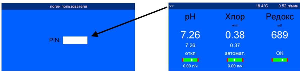
**Внимание:** страницы веб-сервера находятся на SD-карте, и поэтому при отсутствии SD-карты веб-сервер выдает лишь одну страницу с текущими параметрами воды бассейна «MRD3 7.26pH 0.38ppm 689mV 0.52l/min»
