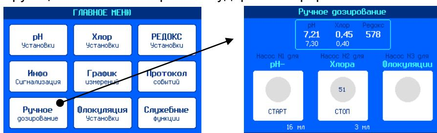
Нажатием на символ насоса можно включить и выключить соответствующий дозирующий насос. Время работы дозирующего насоса ограничено и составляет 60 секунд. Оставшееся время работы насоса отображается в центре картинки соответствующего насоса. Под насосом отображается количество прокаченого химического вещества.
